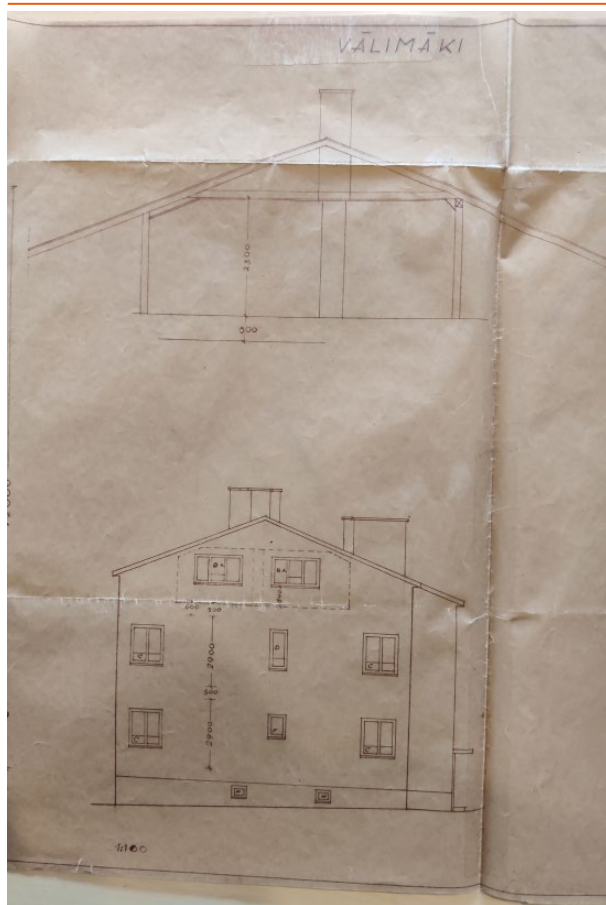
Kuva 41. Ote nykyisen omistajan hallussa olevasta rakennustyöselosteesta. Oheisessa otteessa on rakennuksen itäpäätty ja ullakon rakenteita.
