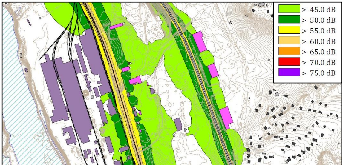
Kuva 7. Yöajan keskiäänitaso LAeq, 7-22, ennuste 2040.
